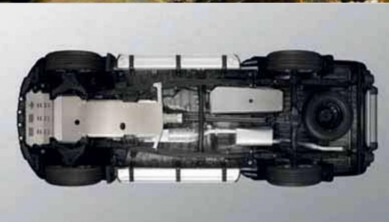
**Защита моторного отсека алюминиевая толщиной 6 мм**
