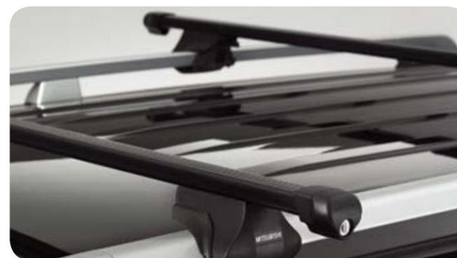
**Дуги багажника поперечные с замком**
