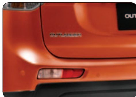
▲ Задня допоміжна система паркування 4 датчики, пофарбовані в колір кузова. For part number see quick reference list.
