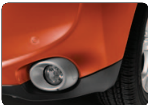
▲ Передня допоміжна система паркування 2 датчики, пофарбовані в колір кузова. For part number see quick reference list.
